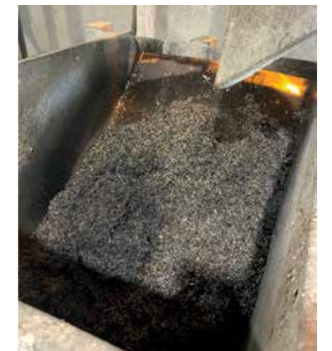
Oben: In der Aufbereitungshalle der LEIPA Papierfabrik. Hier wird der Abfall aus dem im Wasser gelösten Altpapier entfernt. Unten: Metallteile, die mit einem starken Magneten aus dem Papierbrei entfernt wurden. Fotos: D. Meier-Schindler
